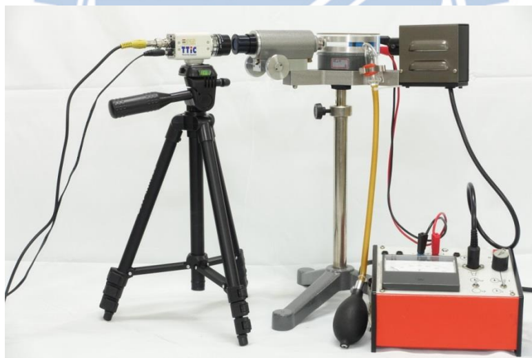
圖三 密立根油滴實驗裝置圖。
