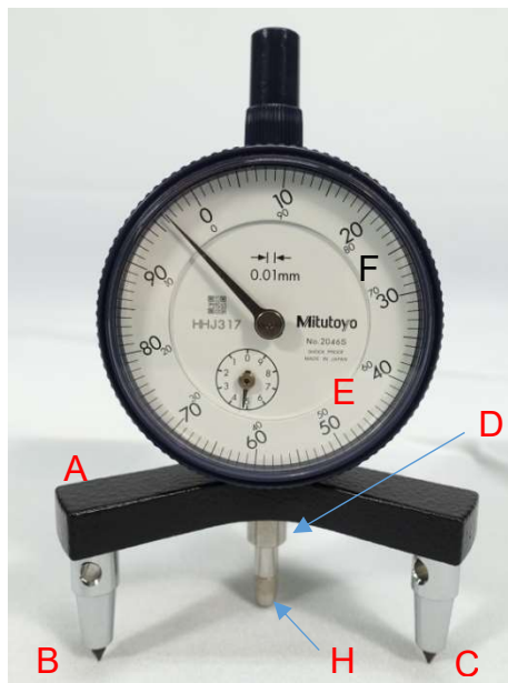
圖一 球徑計構造圖。
