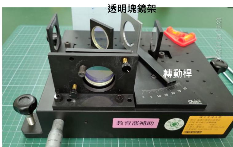
圖六 麥克森干涉儀平台照片。
